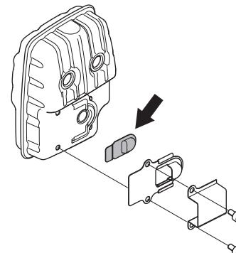
Если сетка часто бывает засорена, значит функция катализатора ухудшена. Обращайтесь к вашему продавцу за советом. Засорение сетки вызовет перегрев двигателя и повреждение цилиндра и поршня.
