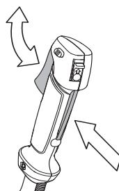
См. указания в разделе Запуск. Включите машину и полностью откройте дроссель. Отпустите рычаг дросселя и удостоверьтесь, что режущее оборудование останавливается и остается неподвижным. Если после постановки дросселя в положение холостого хода режущие оборудование продолжает вращаться, следует проверить регулировку холостого хода карбюратора. См. указания в разделе Техническое обслуживание.
