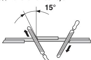
Отрегулируйте разводку. Она должна составлять 1 мм.
