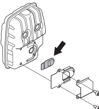
Если глушитель на вашей машине дополнительно оборудован искрогасящим фильтром, его следует регулярно прочищать. Забившийся фильтр может вызвать перегрев двигателя и привести к серьезным повреждениям двигателя.
